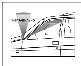
Рис.1 Направление фотодатчика в салоне автомобиля
